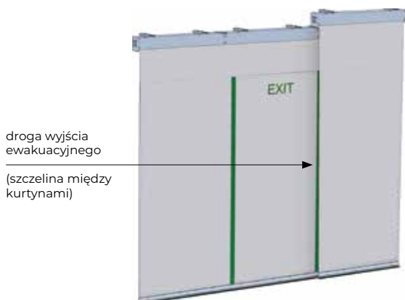
Rys. 35 Wyjście ewakuacyjne wykonane w kurtynach
